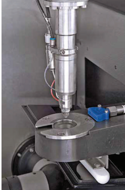
Messzelle für die Erfassung der Laserenergie innerhalb des Wasserstrahls.
